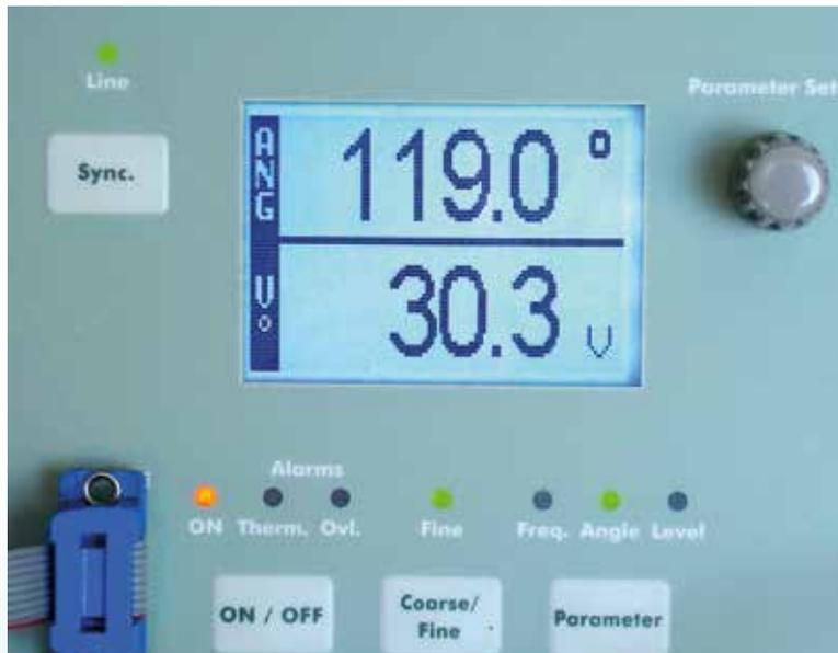
El módulo PTE-FCN del PTE-100-C Pro es una fuente de voltaje extremadamente versátil y precisa para las pruebas monofásicas de relés direccionales, protecciones de generador y sincronizadores. Este módulo se puede añadir al PTE-100-C en cualquier momento.
